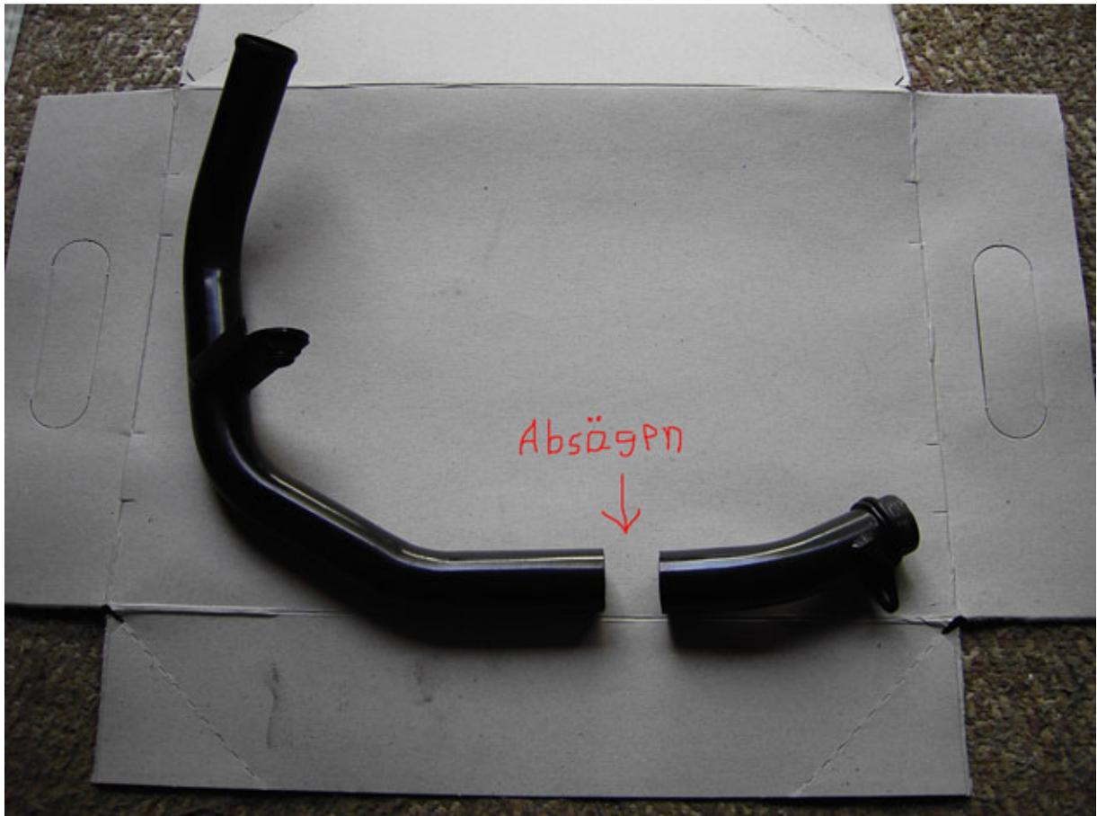
Den 19mm Schlauch als Verbindung vom Kühler zum Schmalen Ende des Kupferbogens nehmen.
